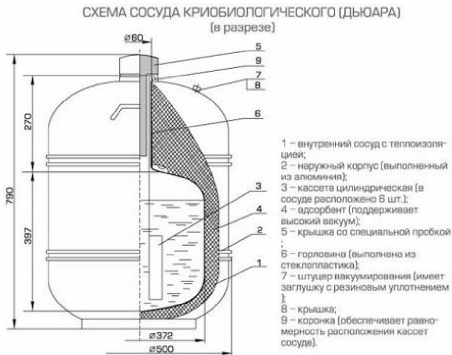
Рис. 1.7 -Схема сосуда криобиологического (дьюара)
