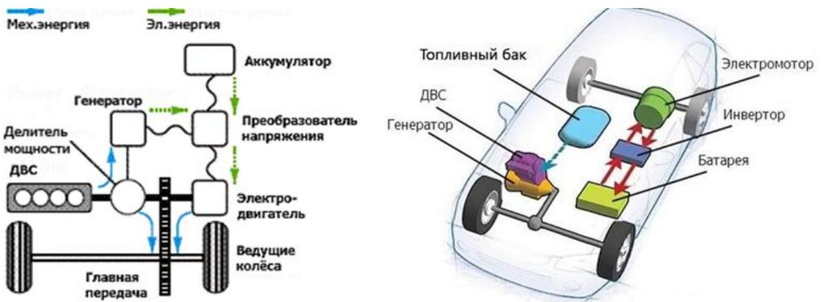
Рисунок 1.14 – Последовательно-параллельная схема привода
