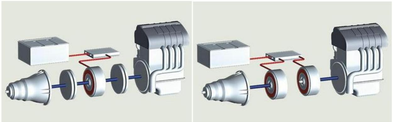
Рисунок 1.10 – Структурная схема полного гибрида (полный параллельный гибрид и полный последовательный гибрид)
