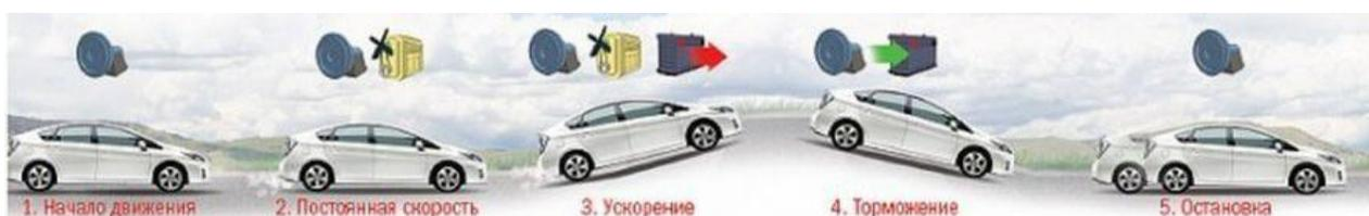
Рисунок 1.3 - Принципы работы гибридного автомобиля во время движения
