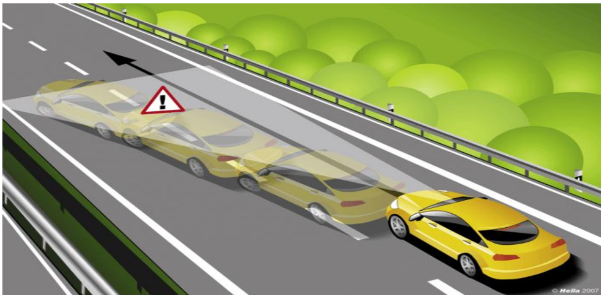
Рисунок 2.20 – Система контроля схода с полосы движения помогает предотвратить лобовое столкновение[25].
