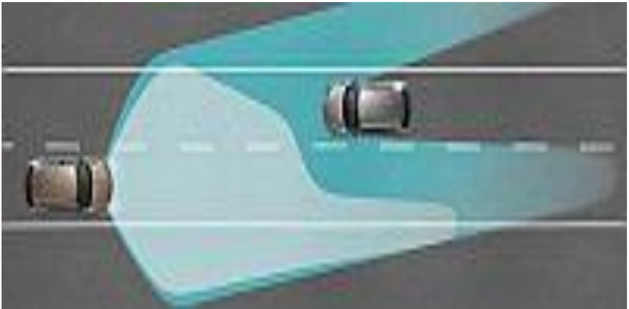
Рисунок 2.17 – Система автоматического переключения дальнего/ ближнего света[22].
