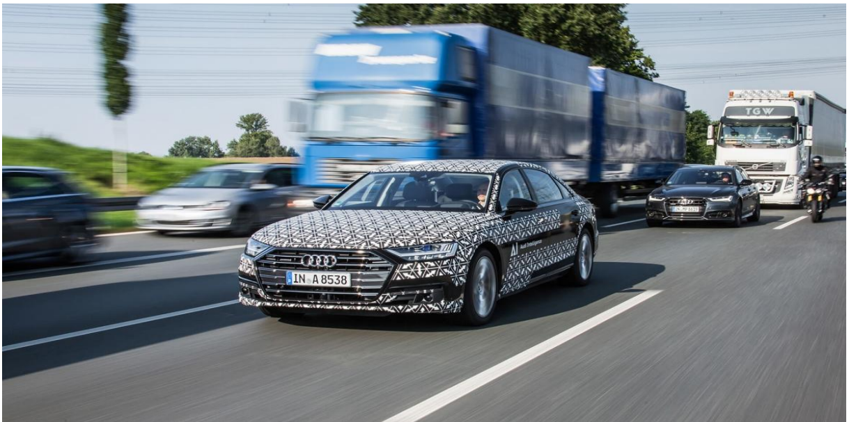
Рисунок 2.14 – Ассистент движения в пробке управляет автомобилем на скорости до 60 км/ч при движении в заторе, плотном потоке [19].
