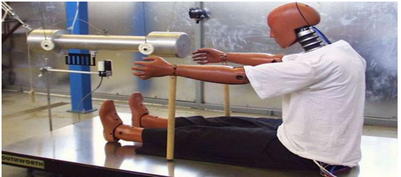
Рисунок 3.3- Голова, шея, грудь и ноги манекена оснащены точнейшими датчиками — всего 34 штуки [57].
