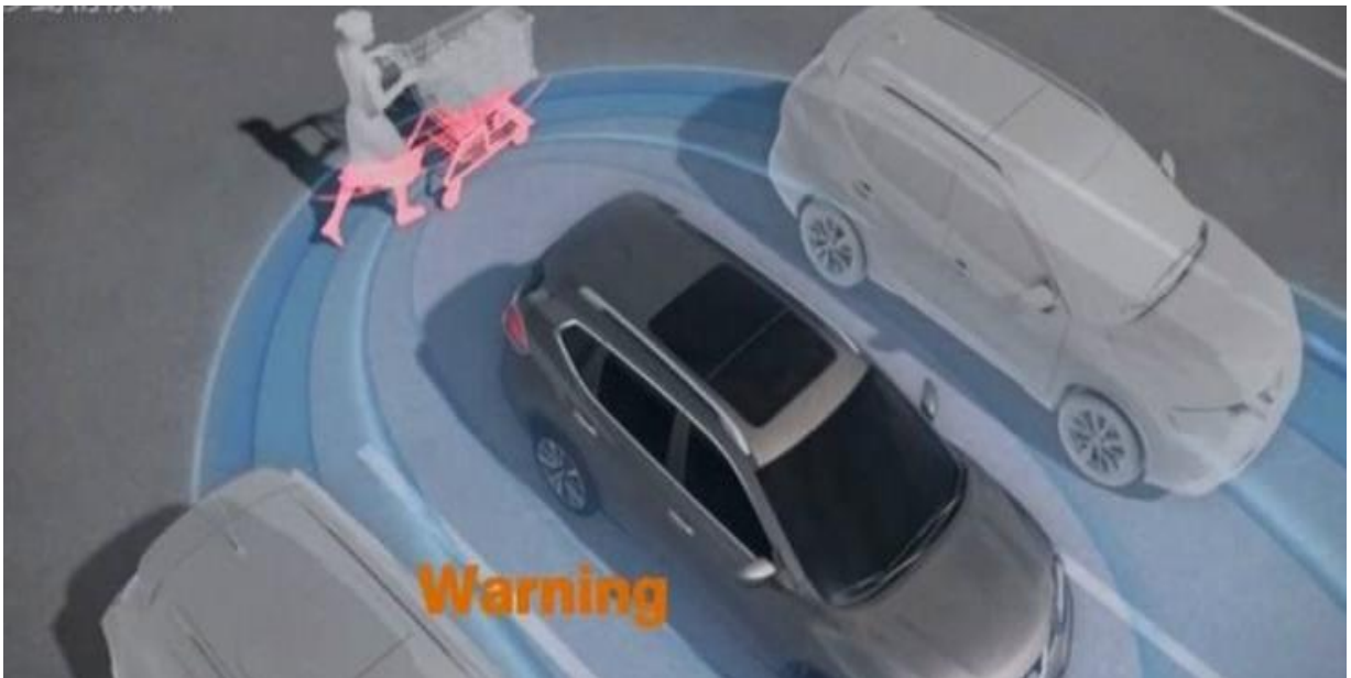
Рисунок 2.4 - Система распознавания движущихся объектов [9].
