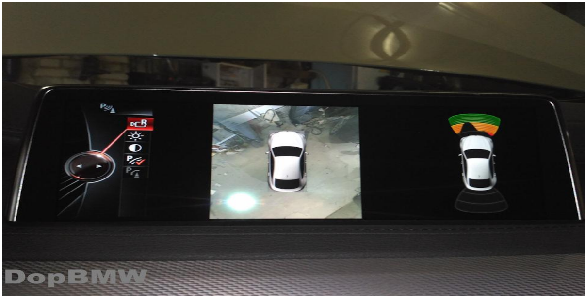
Рисунок 2.28 - Система кругового обзора устанавливается, в основном, на автомобилях премиум-сегмента [33].
