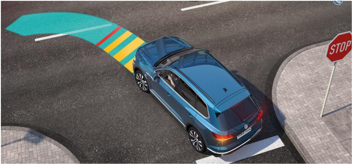
Рисунок 2.6 - Оказание поддержки при выезде из зон со «слепым» обзором [11].
