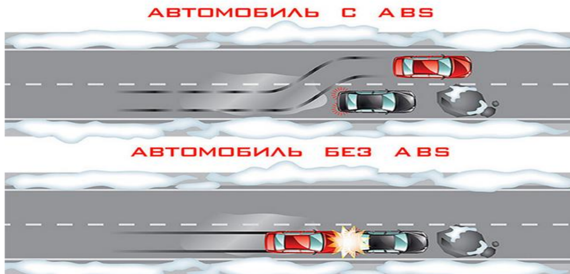
Рисунок 2.27 - Пример остановки автомобиля с ABS и без него [32].
