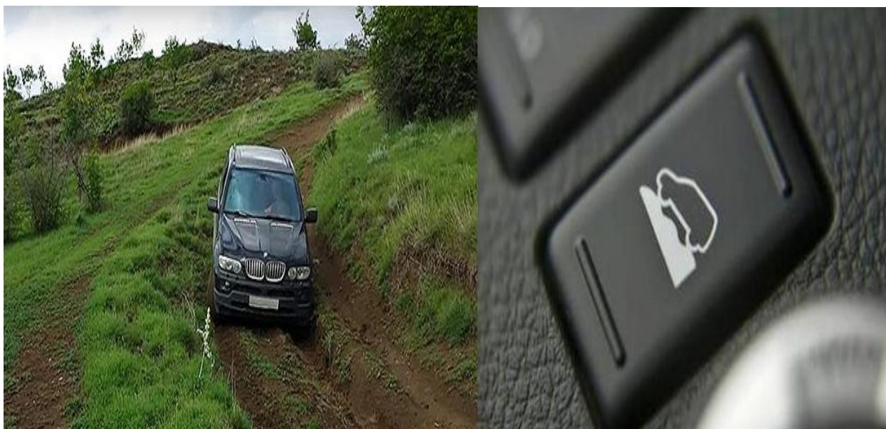
Рисунок 2.12 – Ассистент спуска со склона (Hill descent control) [17].
