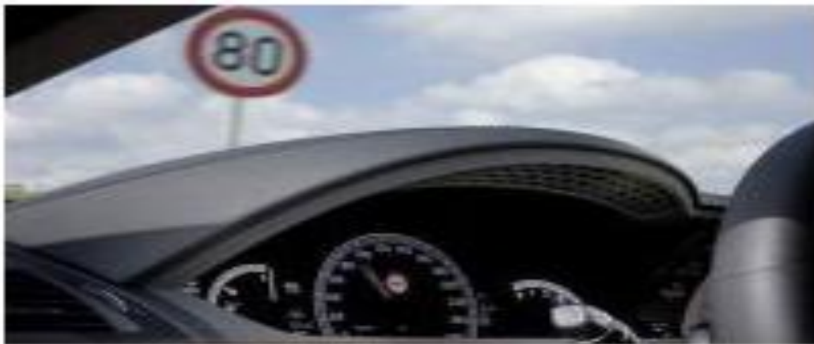
Рисунок 2.30 - Изображение в виде знака ограничения скорости выводится на дисплей комбинации [35].
