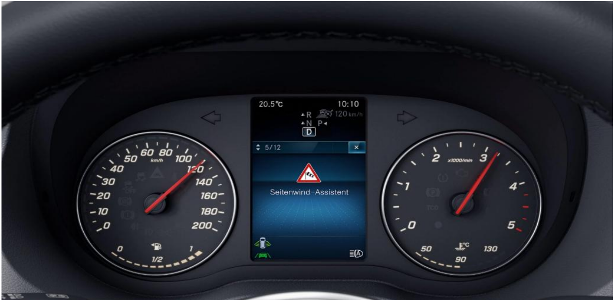
Рисунок 2.43 – Ассистент бокового ветра [48].
