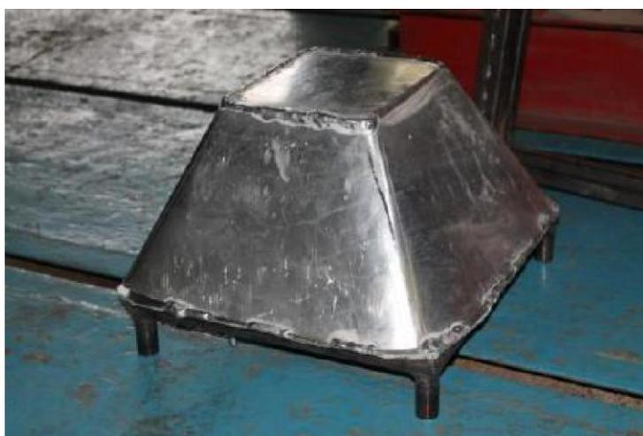
Рисунок 1.2 - Атенюатор, изготовленный из алюминия
