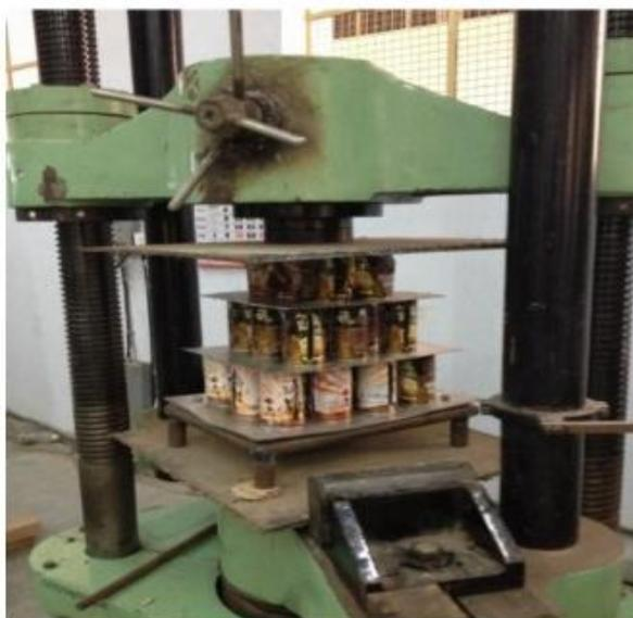
Рисунок 1.25 - UTM машина для испытаний
