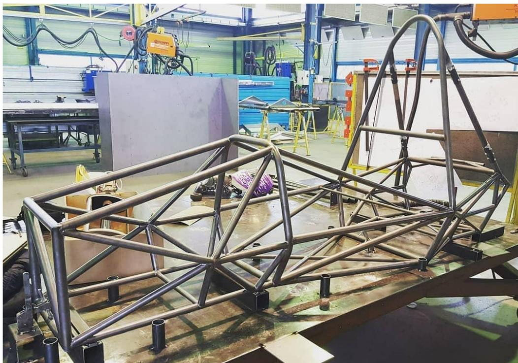
Рисунок 2.6 – Рамная конструкция команды L'Écurie Piston Sport Auto (Лион, Франция)
