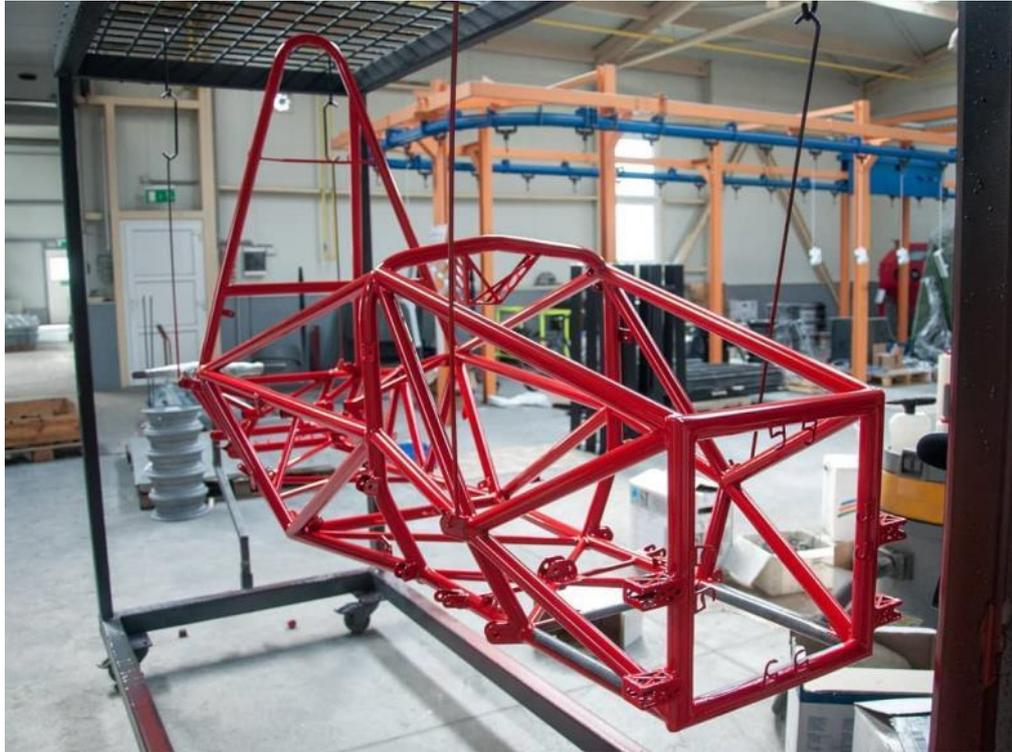
Рисунок 2.5 – Рамная конструкция команды Arrabona Racing Team (Дьер, Венгрия)
