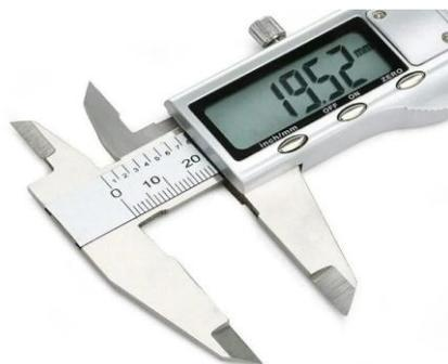
Рисунок 2.50 - штангенциркуль с цифровой индикацией
