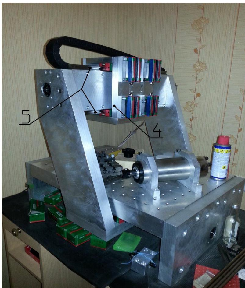
Рисунок 2.38 – альтернативная конструкция каретки оси X для оси Z,
