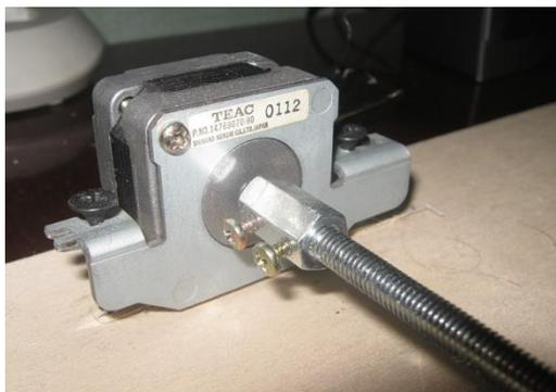
Рисунок 2.11 – шпилька в качестве ходового винта
