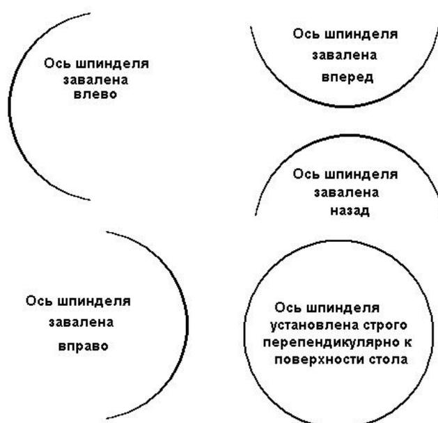
Рисунок 2.45 - юстировка перпендикулярности оси вращения шпинделя
