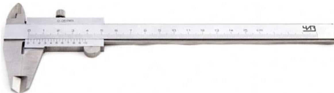
Рисунок 2.49 – штангенциркуль механический
