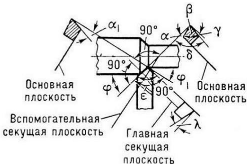
Рисунок 4.2 - Обработка точением
