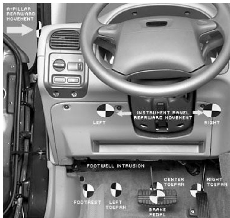
Рисунок 3. 1 – Типовая схема замеров деформаций салона после фронтального удара
