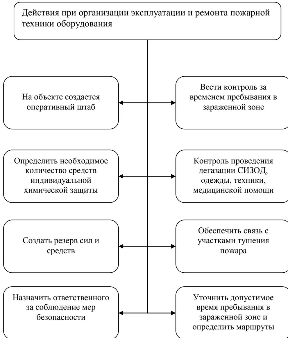
Рисунок 5 - Действия при организации эксплуатации и ремонта пожарной техники, оборудования
