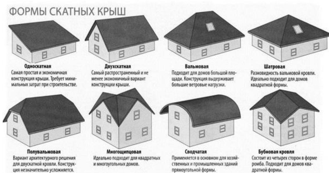
Рисунок 1.2 - Виды крыш скатного типа.
