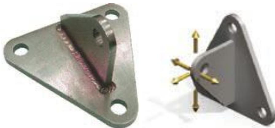
Рисунок 3.4 - Концевой структурный анкер. Возможное направление нагрузки. Прочность детали  $F_k = 35\text{кН}$ .
