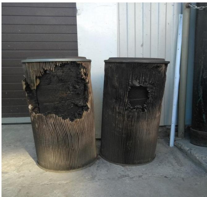
Рисунок 3.1 – Внешний вид фильтров после последовательной резки стали и алюминиевых сплавов
