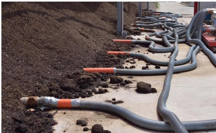
Рисунок 1.1 - Промышленный компост с принудительной аэрацией
