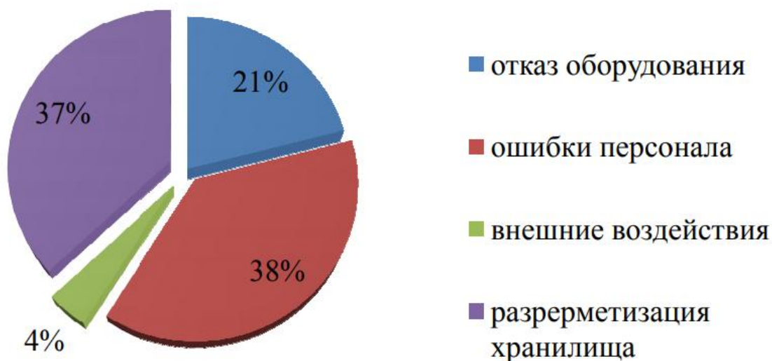
Рисунок 6 – Основные причины аварий на химических предприятиях РФ
