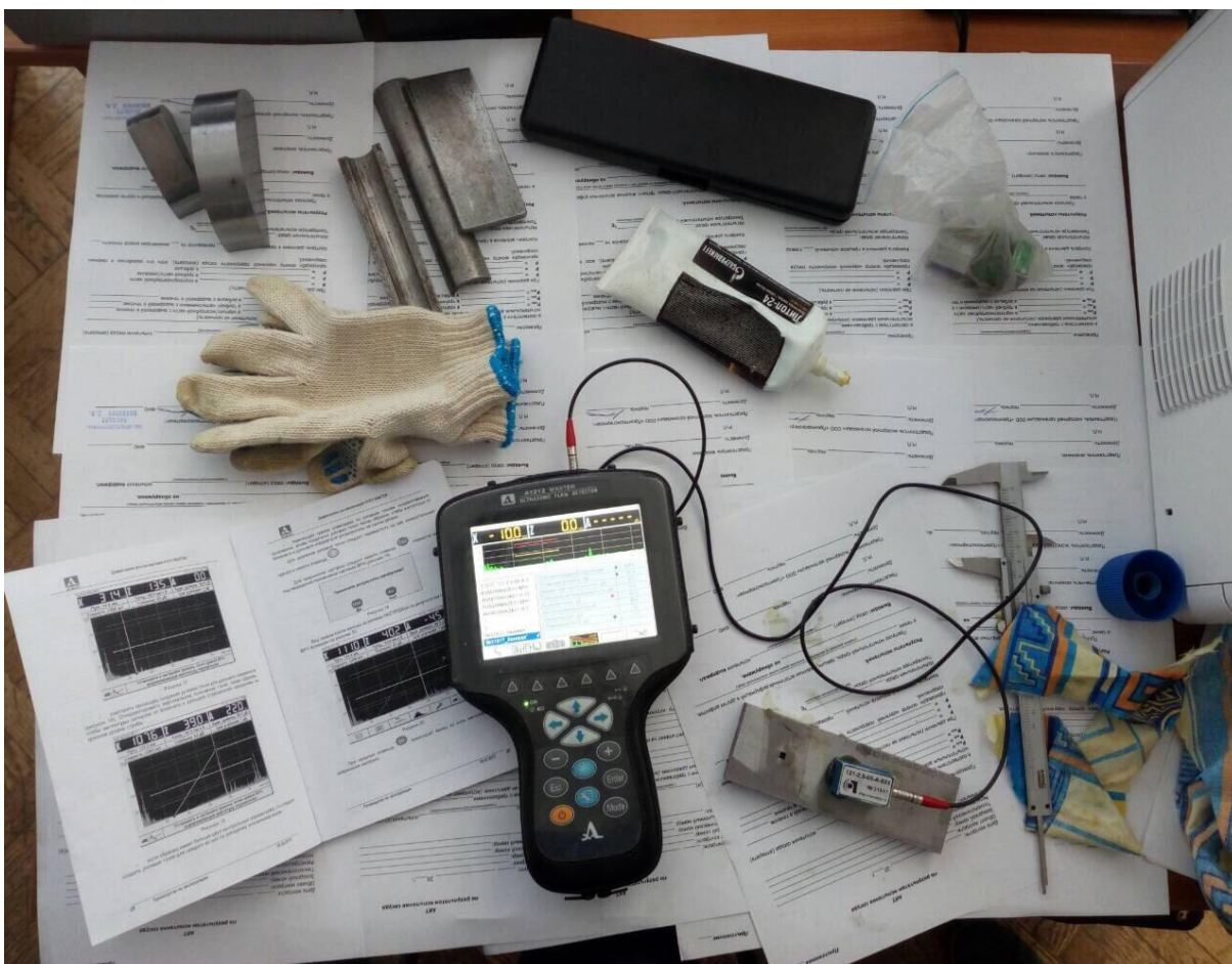
Рисунок 2.6 – Ультразвуковой дефектоскоп для проведения неразрушающего контроля
