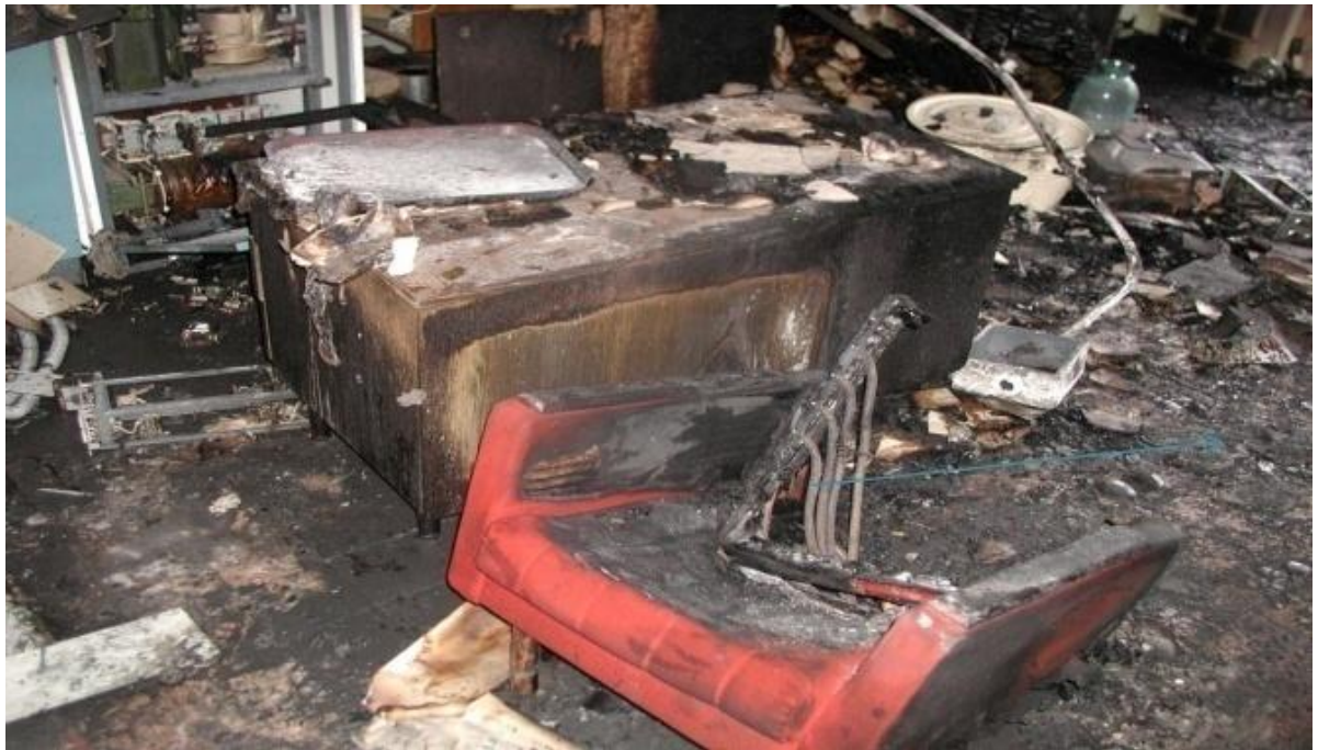
Рисунок 5 - Мебель и оборудование подверженное обугливанню со стороны обращенной к месту возникновения пожара
