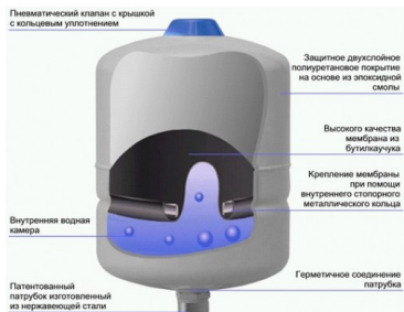
Рис. 3. Накопительный бак для фильтра обратного осмоса [1]
