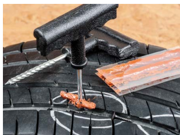
Рис. 1. Ремонт шины с помощью жгута (а) и пластыря (б)
