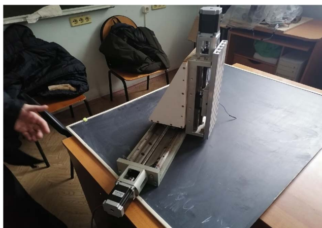
Рис. 1. Макет разрабатываемого малогабаритного настольного станка с ЧПУ на базе персонального компьютера
