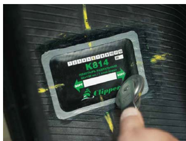
Рис. 1. Ремонт шины с помощью жгута (а) и пластыря (б)
