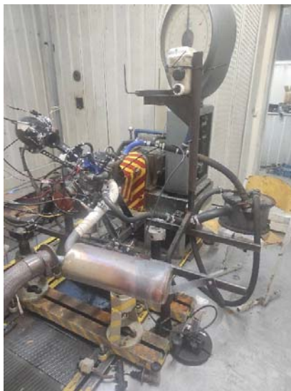
Рис. 2. Вывешивание двигателя через пространственную раму на опорных стойках
