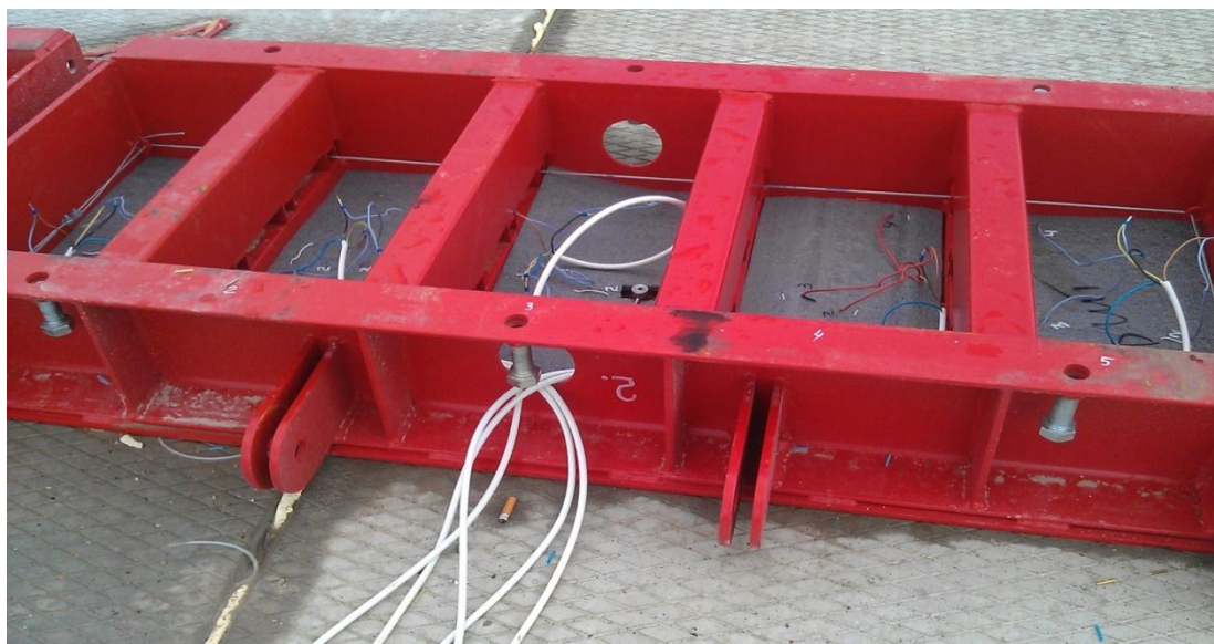
Рисунок 34 – поддон опалубки с нагревательными элементами
